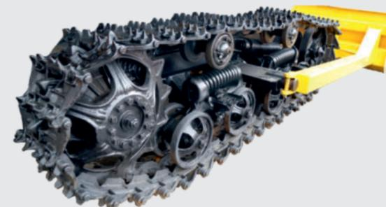
Торфяная модификация трактора АГРОМАШ 90ТГ предназначена для использования на сельскохозяйственных, мелиоративных, строительных и других операциях на почвах с повышенной и чрезмерной влажностью, заболоченных участках и слабонесущих почвах.
